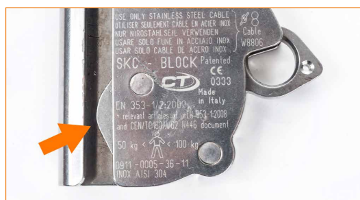
Came de blocage qui ne revient pas automatiquement en position.
