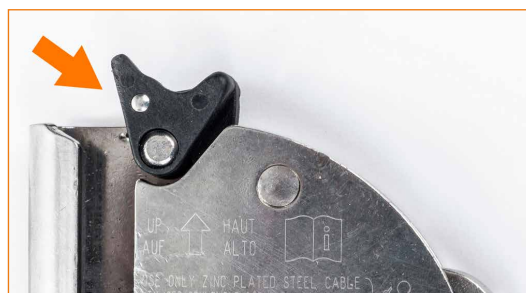
Gâchette de sécurité qui ne revient pas automatiquement en position.
