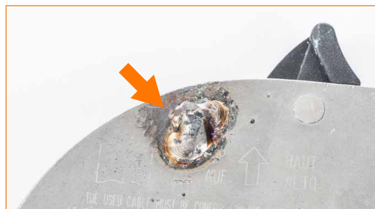
Signe de soudure à proximité du rivet.
