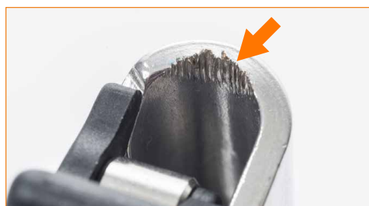
Dispositif qui a arrêté une chute : bord du corps présentant des entailles dues au coulisement du câble.
