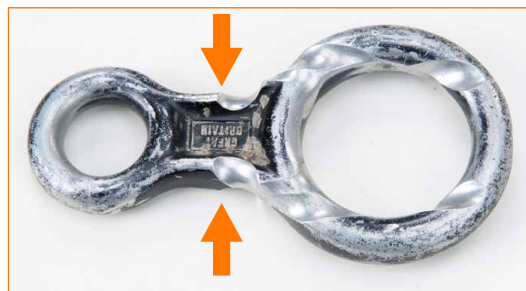
Dispositivo con evidenti segni di usura (superiori a 1 mm).
