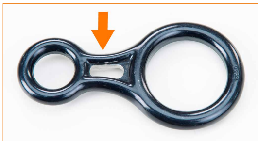
Dispositivo modificato senza autorizzazione fuori dall'unità produttiva.
