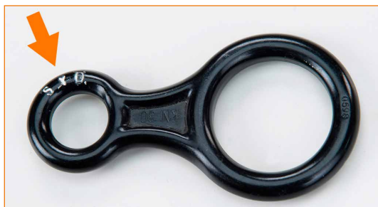
Dispositivo modificato senza autorizzazione fuori dall'unità produttiva (incisioni superiori a 1 mm).
