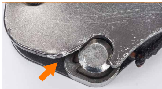
Placa lateral móvil con deformación que impide el enganche con el perno de cierre.
