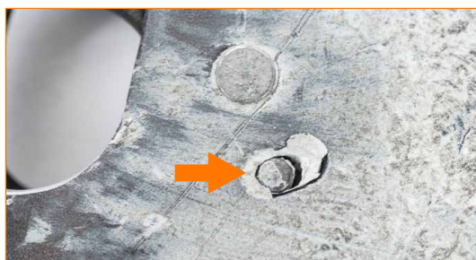
Dépôt de résidus durs dans la cavité présente sur le côté arrière de l'EPI.
